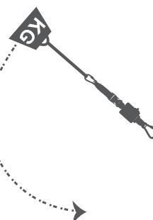
Se une el lanyard a un punto de anclaje y al otro extremo se le aplica la carga. Se eleva la carga por encima del punto de anclaje y se suelta, 5 veces.
